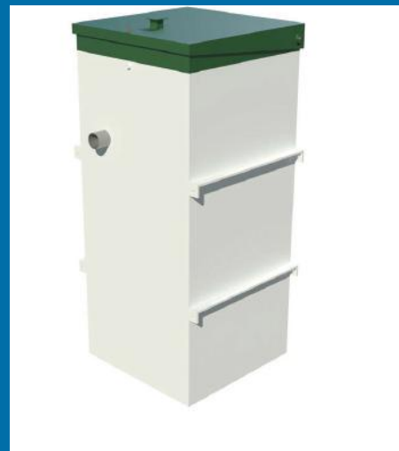
ТОПАС 6 Хүний тоо:6 Хүчин чадал:1200л Цахилгаан:1,6 квт Жин:250кг 1080/1170/2500мм
