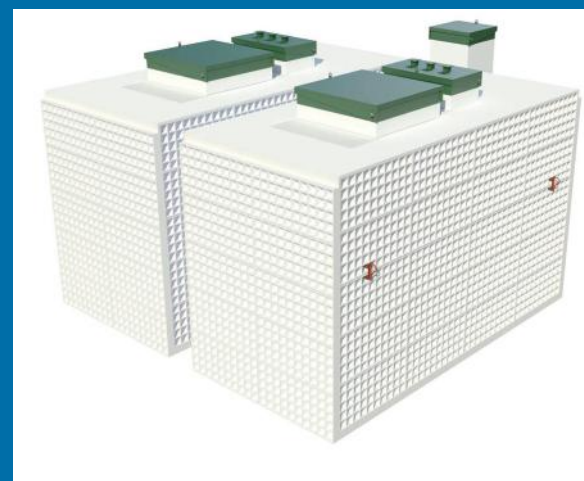
ТОПАС 150 Хүний тоо:150 Хүчин чадал:24000л Цахилгаан:23,6квт Жин:2045кг 3200/4700/3000мм
