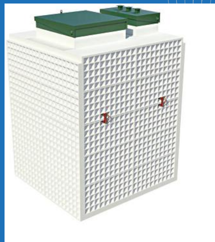
ТОПАС 40 Хүний тоо:40 Хүчин чадал:7000л Цахилгаан:6,3 квт Жин:970кг 2200/1700/3100мм
