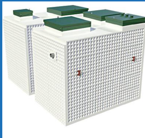
ТОПАС 100 Хүний тоо:100 Хүчин чадал:0.16000л Цахилгаан:14,7квт Жин:1620кг 3200/4700/3000мм
